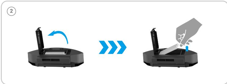
Reinigen Sie den Filter mit dem Reinigungswerkzeug und spülen Sie den Filter und die Staubbox bei Bedarf gründlich mit Wasser aus. Anschließend müssen alle gereinigten Elemente gründlich getrocknet werden.
