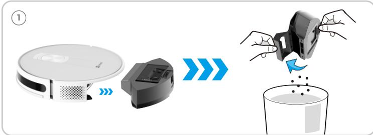
Nehmen Sie den Filter aus dem Filterkasten heraus.
