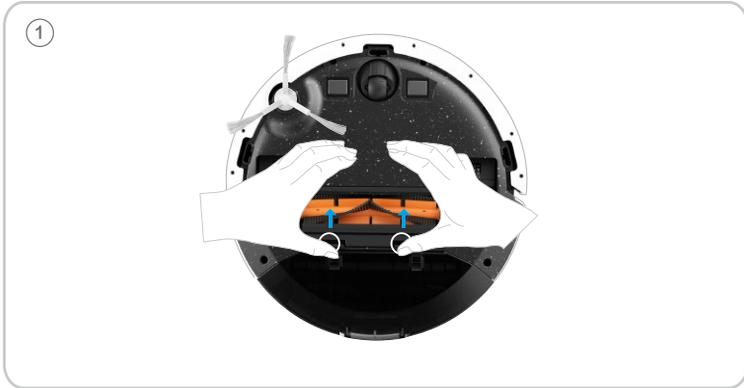
Schneiden Sie mit der Klinge des Reinigungswerkzeugs die Haare ab, die sich auf der Hauptbürste verfangen haben, und entfernen Sie die Walze an einem Ende der Hauptbürste, um sie zu reinigen, und setzen Sie dann die Hauptbürste wieder ein.
